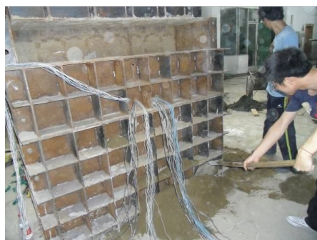
(b) 模型入位并回填上覆土
