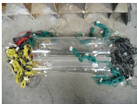
(c) 贴好应变片的隧道模型
